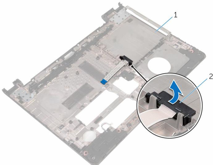
1 Osnovna plošča računalnika      2 Vmesnik optičnega pogona
