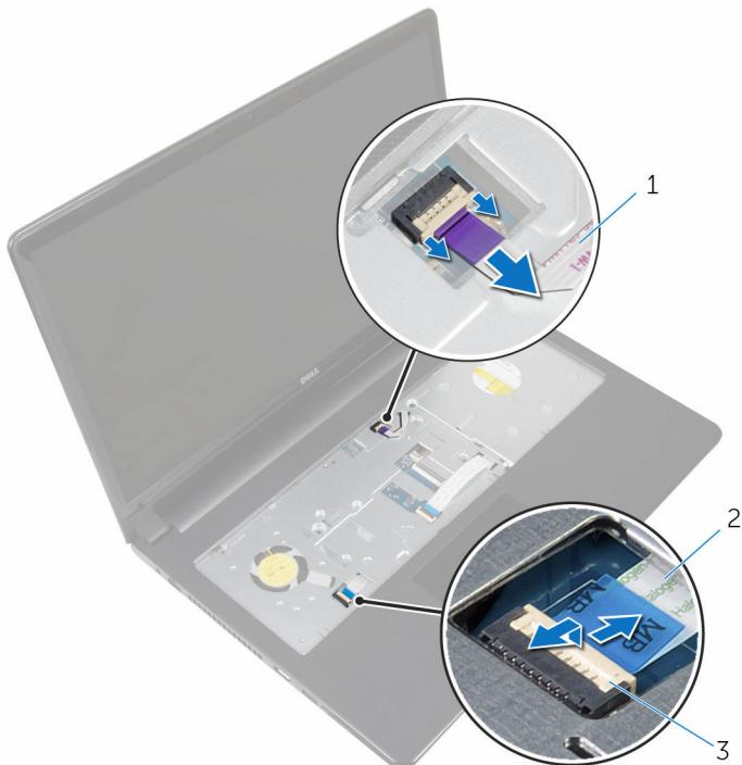
1 Kabel plošče gumba za vklop
