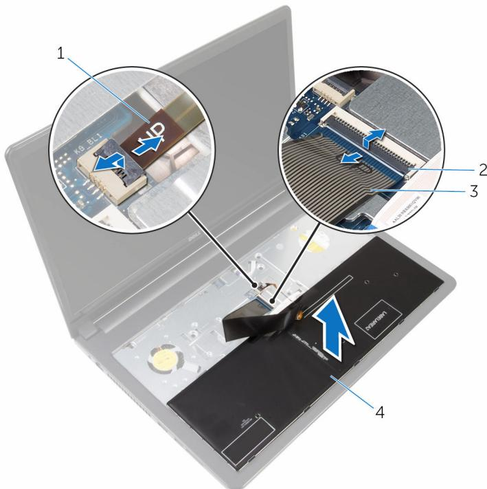
1 Kabel za osvetlitev
